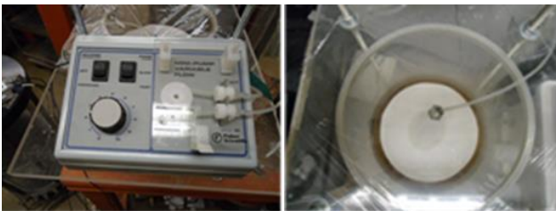
Figura 3. Bomba peristáltica utilizada para impor fluxo de água ao sistema e detalhe da instalação de papel filtro na superfície da coluna.
