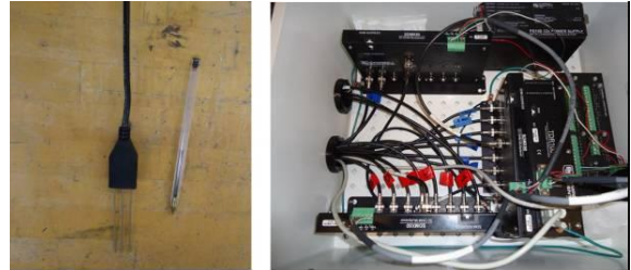
Figura 4. Detalhe do sensor para medida de umidade (a) e o datalogger para armazenamento dos dados (b).
