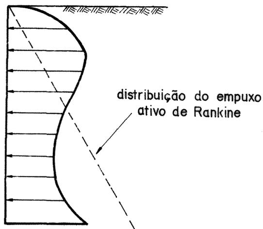
Fig. 2.1 - Distribuição típica de tensões numa escavação escorada
