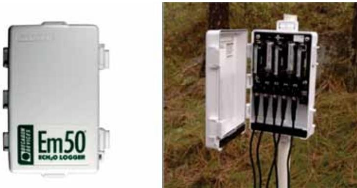
Figura 16 – Recipiente de proteção do *datalogger* e detalhe do equipamento aberto com as conexões para os sensores (Fonte: [www.decagon.com](http://www.decagon.com))
